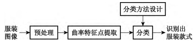
图 1 服装款式识别新方法的流程图
