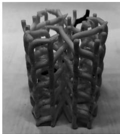
图9 未优化的六角形三维打印几何模型
