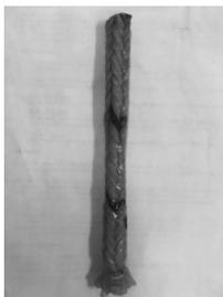
图 6 经环氧树脂固化的六角形编织预制件
